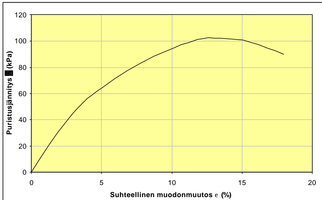
Kuva 2. Finncao-kuitusavien tyypillinen jännityksen ja muodonmuutoksen välinen vuorosuhde yksiaksisiaalisessa puristuskokeessa. Kuvan kuitusavinäyte (ryhmä A) on Koivissillan kaatopaikan tiivistyskerroksesta ( w = 99,4 \% , g_t = 6,2 \text{ kN/m}^3 , koestusikä 3 v).
